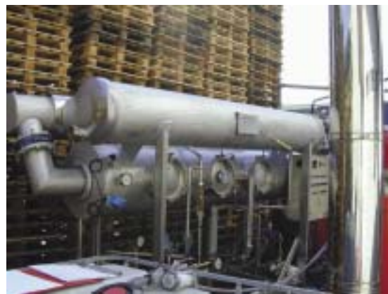
Photo 3 : Evaporation sous vide matériel Entropie (source ITV France - Unité de Tours)
