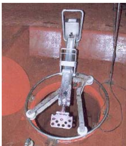
Photo 1 : Robot pigeur Seguin Moreau (source ITV France - Unité de Bordeaux-Blanquefort)
