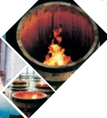
Chauffe de recuisson, brûlage.
